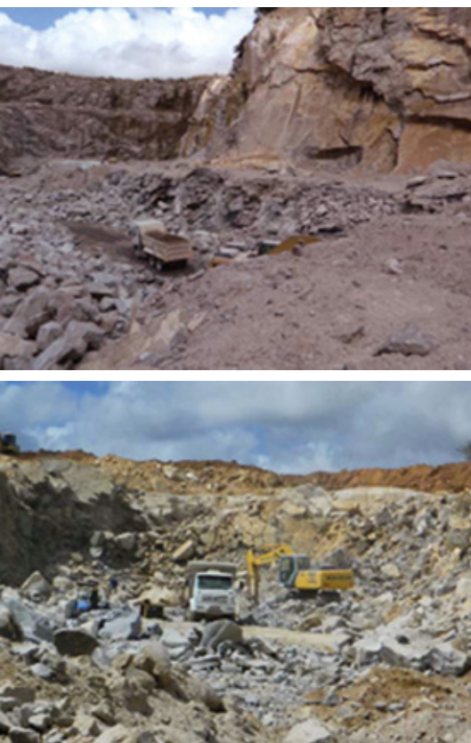
Figuras 2 – a) Extração a céu aberto em bancadas na pedreira Ferreiro Torto. b) Pilha de rocha desmontada (Fonte: SILVA, 2012).
